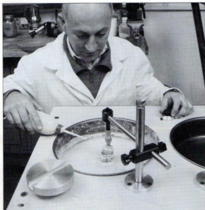
*Il vetro viene asportato per effetto dell'abrasione provocata da una sostanza durissima, l'ossido di Cesio in sospensione acquosa, che deve essere spruzzato a intervalli regolari sulla lente, in modo che questa rimanga costantemente umida. L'operazione di lucidatura può richiedere un tempo da trenta minuti a parecchie ore, in relazione alla quantità di vetro da asportare.*
